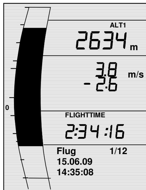
**Внимание:** убедитесь перед взлетом что GPS-приемник получает уверенный сигнал по крайней мере от 4 спутников и что **GPS** символ отображается на экране.
