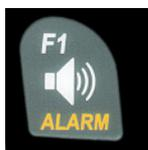
Во время полета сам сигнал может быть включен или выключен путем длительного нажатия на клавишу **Alarm** → Stall и далее выбора значения нажатием F1 / F2.
