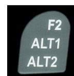
Дисплей альтиметра **Alt1** отображает абсолютную высоту по давлению над уровнем моря. Сразу после включения альтиметр ALT1 автоматически подставляет высоту по GPS сигналу. После включения дисплей будет мигать пока GPS-приемник не получит достаточно точную информацию для вычисления высоты для настройки прибора.
