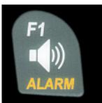
Значение при котором срабатывает сигнал тревоги устанавливается вручную клавишами вверх ▲ или вниз ▼ в диапазоне от -0,1 до -20,0м/с.
